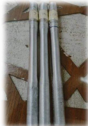
شكل (٨-٢) العينة قبل و بعد عملية الخراطة
