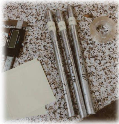
شكل (٨-٢) العينة قبل و بعد عملية الخراطة
