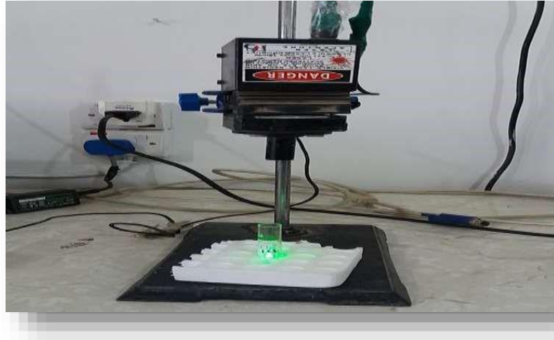
الشكل (3-2) يوضح طريقة التشعيع بليزر الاندي يافو
