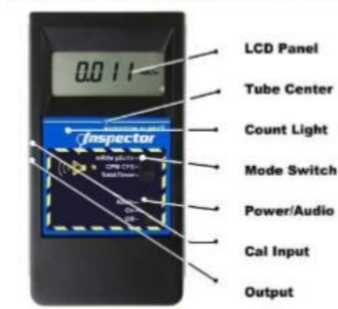
الشكل (3-2) يوضح أجزاء جهاز SE International Inspector Handheld Digital Radiation Alert Detector
