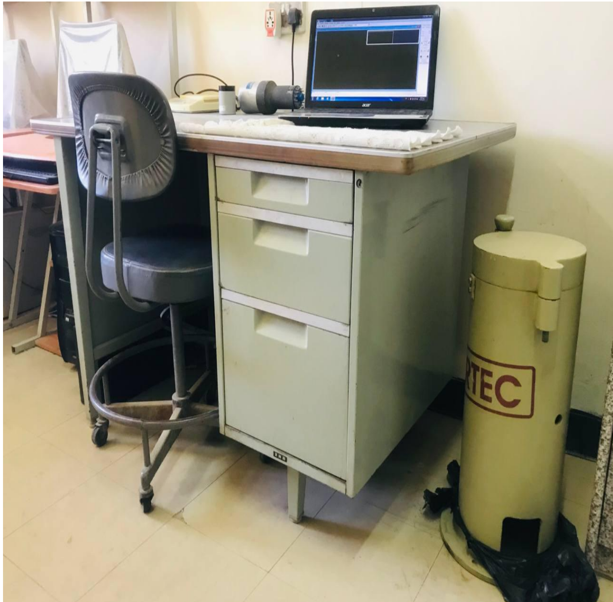
الشكل (٢-٣) يوضح منظومة تحليل اطياف أشعة كاما المستخدمه بالبحث .
