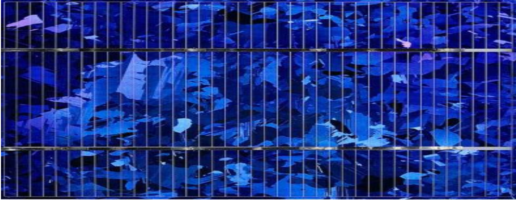
الشكل (2-1)، الألواح الشمسية متعددة البلور. [5]
