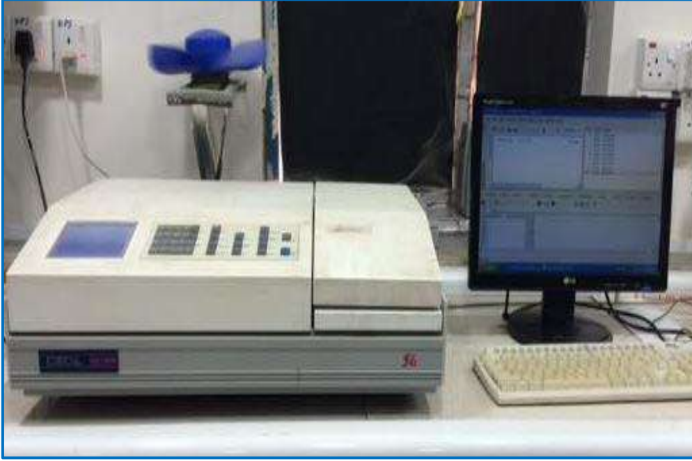
الشكل (3-6) يوضح جهاز قياس طيف الامتصاص المستخدم
