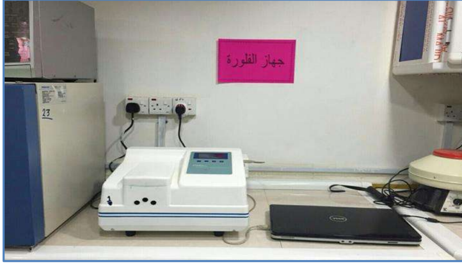
شكل (3-7) يبين جهاز قياس طيف الفلورة المستخدم.
