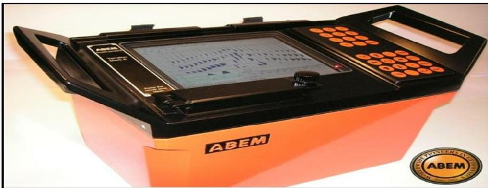
لوحة (١-٢) جهاز التسجيل الزلزالي (ABEM Terraloc Mk-6 Seismic)
