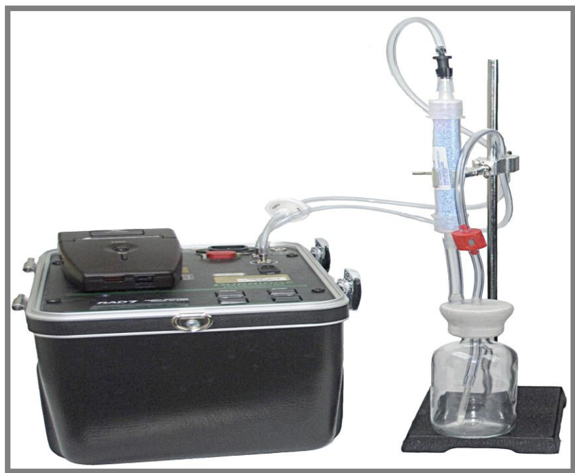
الشكل (11-3) يوضح جهاز RADH 2 O متصل مع RAD7 [69].
