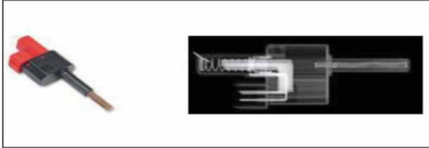
الشكل (٦) صورته رقمية بالأشعة السينية لمكونات مفتاح السيارة لاختبار المكونات الداخلية [١٧]
