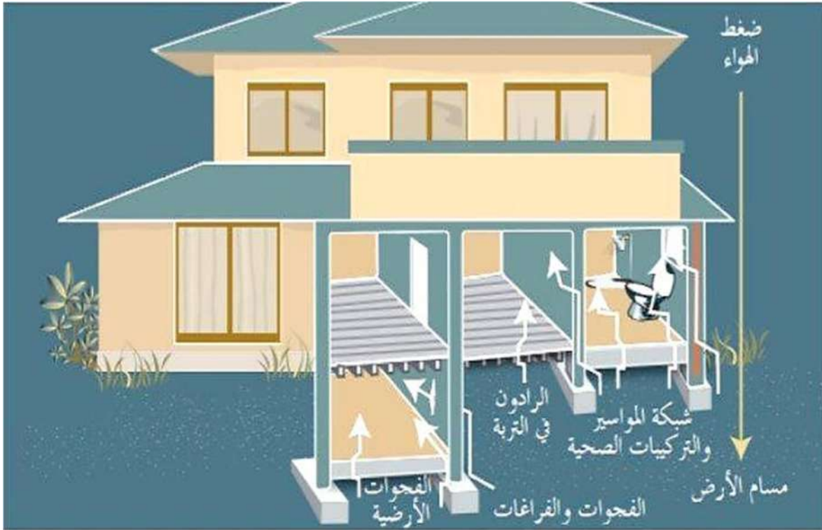
الشكل ( ٢.٢ ) :يوضح كيفية دخول الرادون الى المباني. [١٠]
