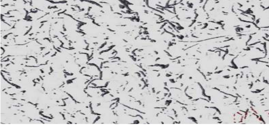
شكل (٣): البنية المجهرية لحديد الزهر الرمادي
