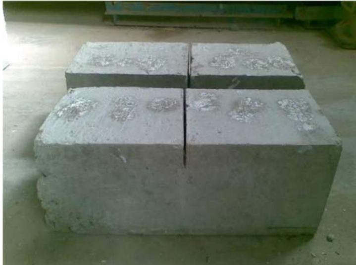
شكل رقم (٣-٧) النماذج المستخدمة لايجاد عمق الشق
