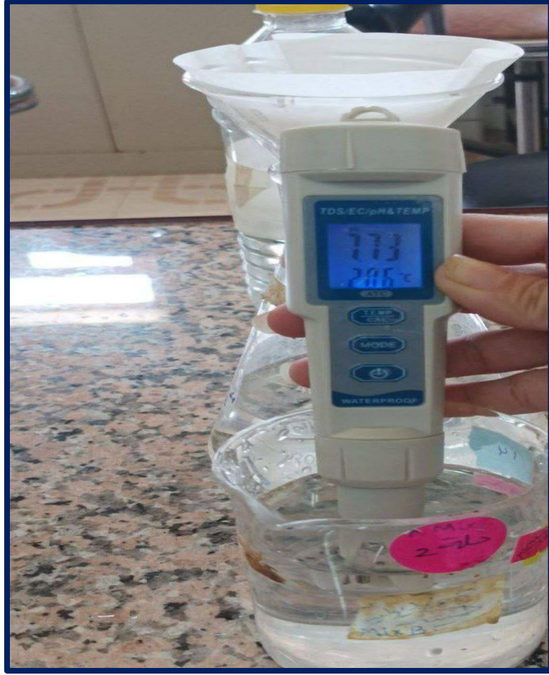
شكل (3,5) يمثل طريقة قياس المواد الصلبة الذائبة في الماء T.D.S لعينة من عينات مواقع منطقة الدراسة
