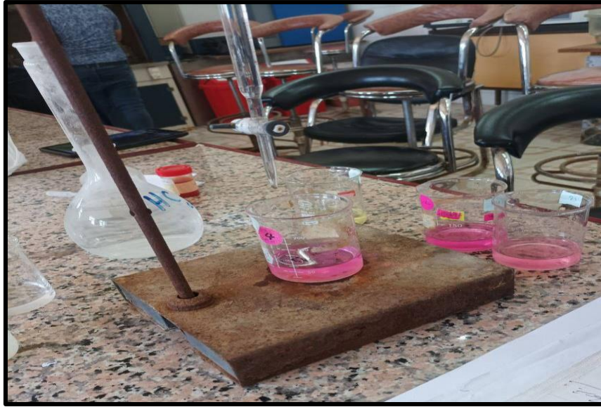
شكل (3,12) يمثل طريقة قياس نسبة أيجاد تركيز الكربونات CO 3 والبيكربونات HCO 3 لعينة من عينات مواقع منطقة الدراسة
