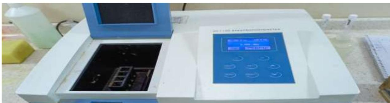
الشكل(8-2)جهاز قياس الامتصاصية
