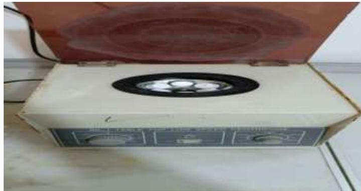
الشكل (2-5) وضع الانابيب الاختبار في جهاز الطرد المركزي
