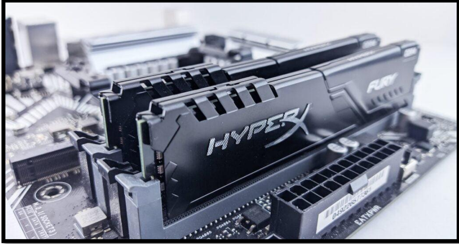
الشكل (2-2) يوضح ذاكرة الوصول العشوائي RAM [20]
