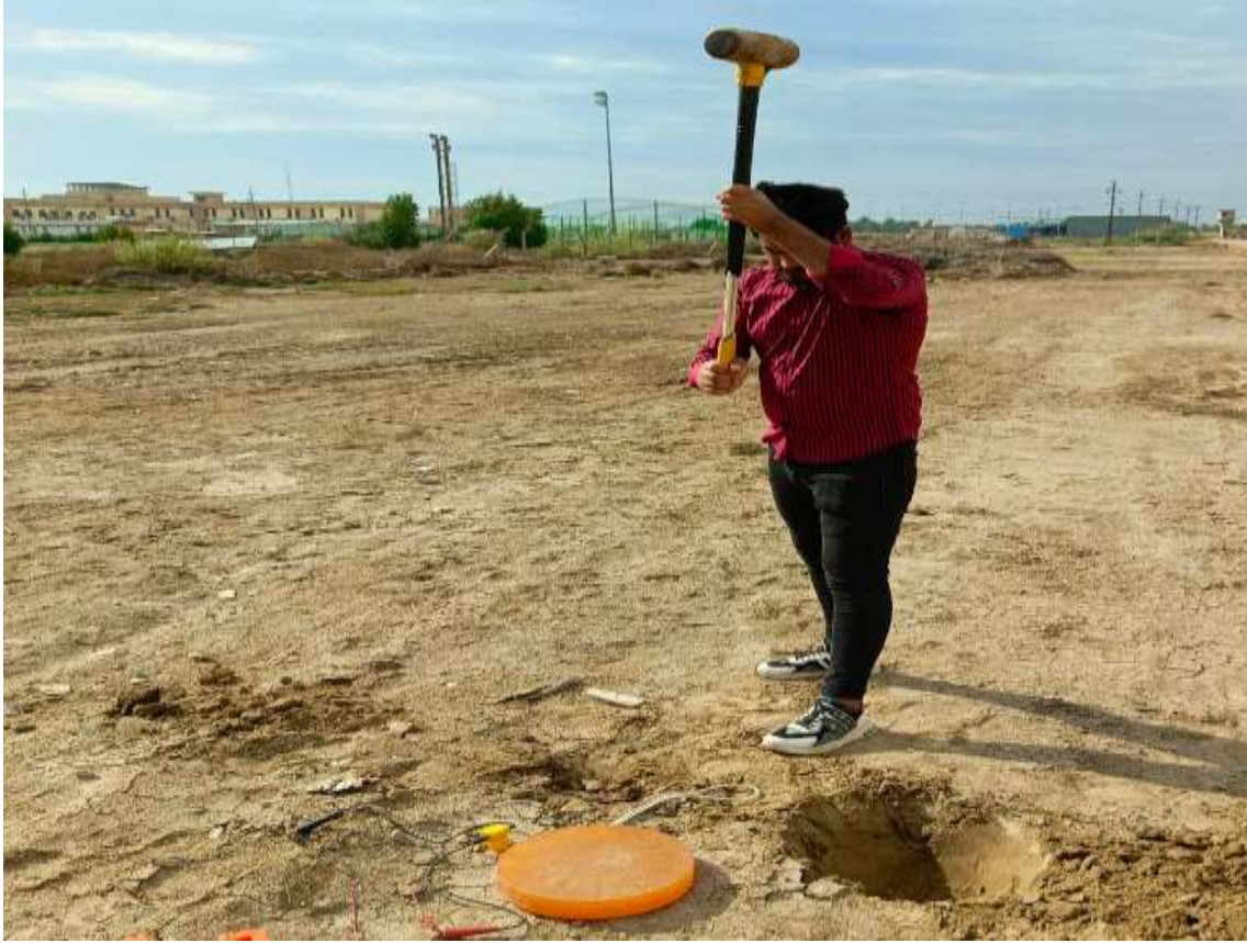
شكل ١٣- استخدام المطرقة اليدوية كمصدر لتوليد الموجات الطولية والمستعرضة
