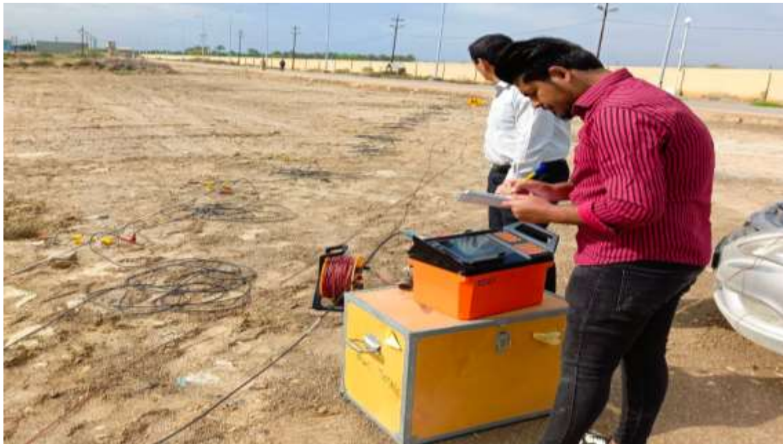
الشكل (١٢) يوضح استخدام المطرقة اليدوية والضرب الموازي لسطح الارض لتوليد موجة مستعرضه S
