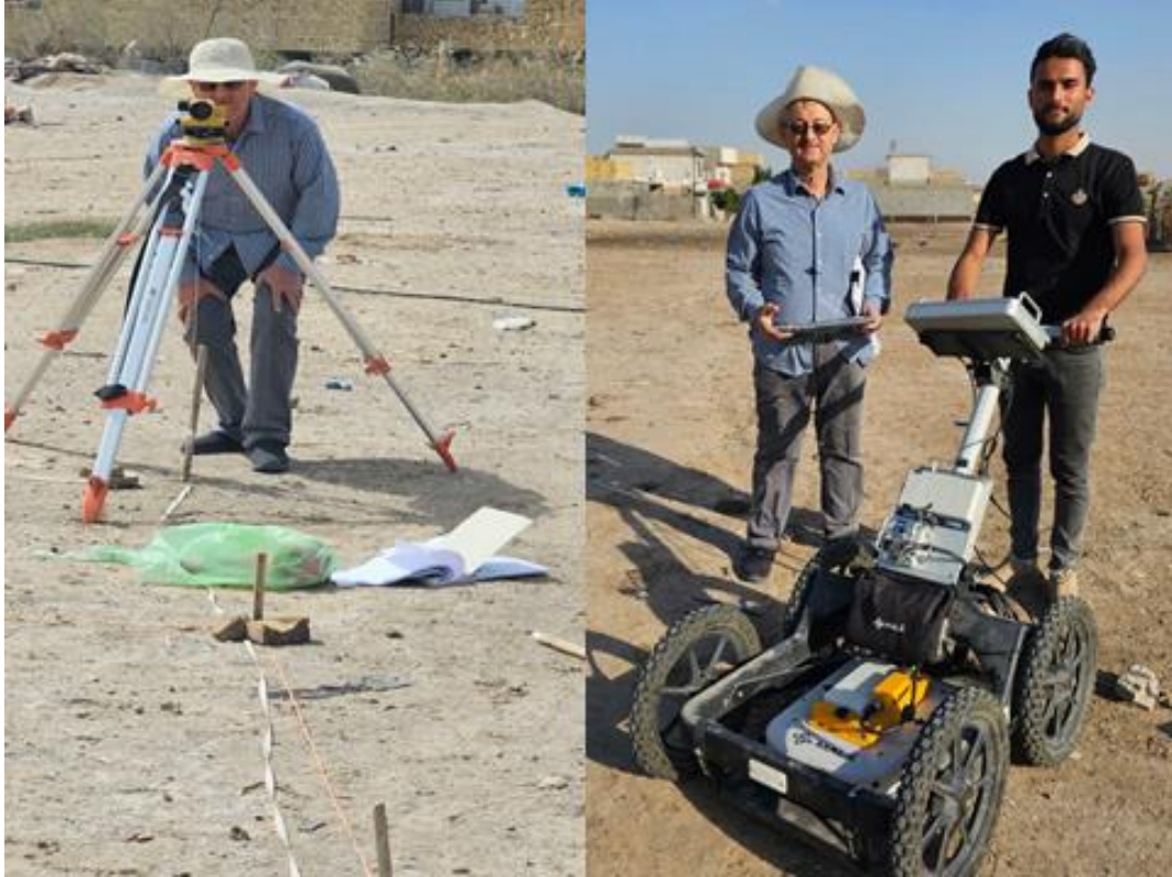
الشكل رقم (9) يوضح استخدام جهاز الثيودلايت والرادار في العمل الحقلی لمنطقة الدراسة
