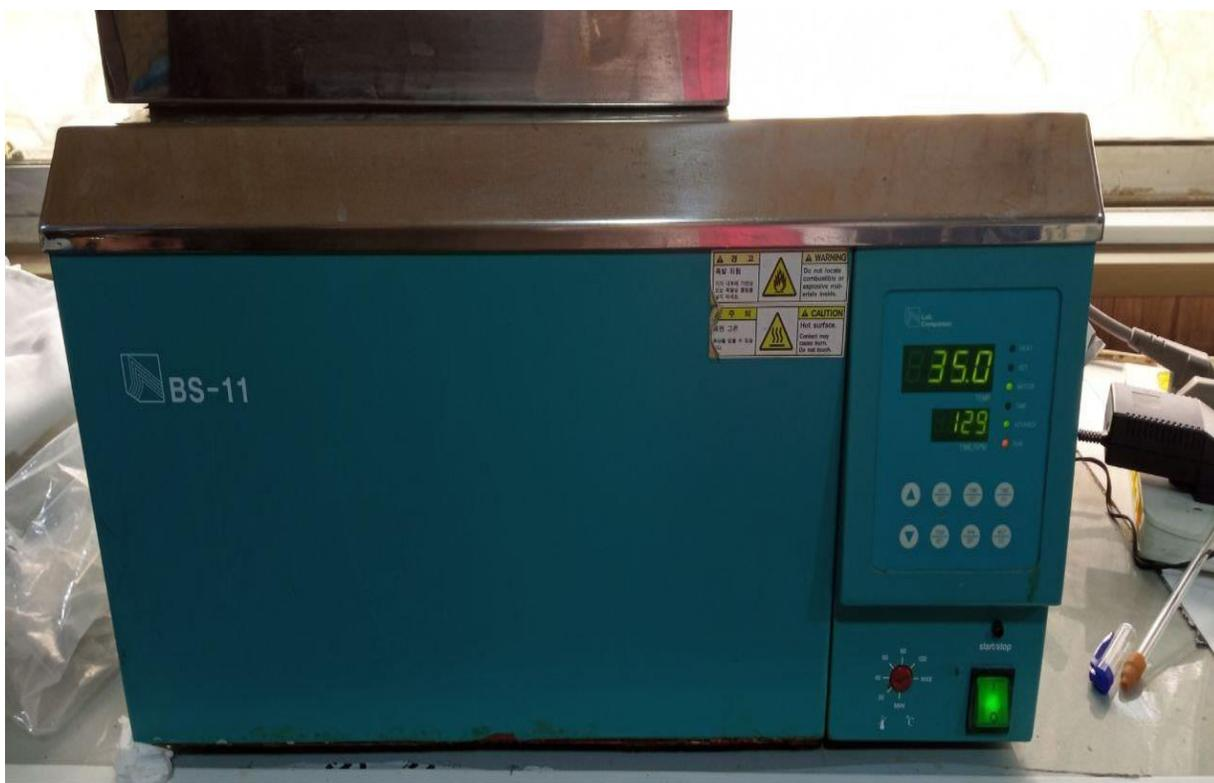
الشكل (2-4): جهاز الحمام المائي المزود بهزاز
