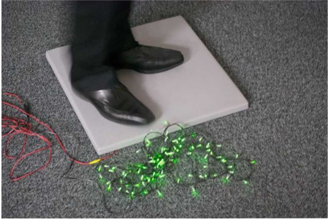
الشكل (1_8) اضاءة المصابيح نتيجة الضغط على المادة البيزوكهربائية
