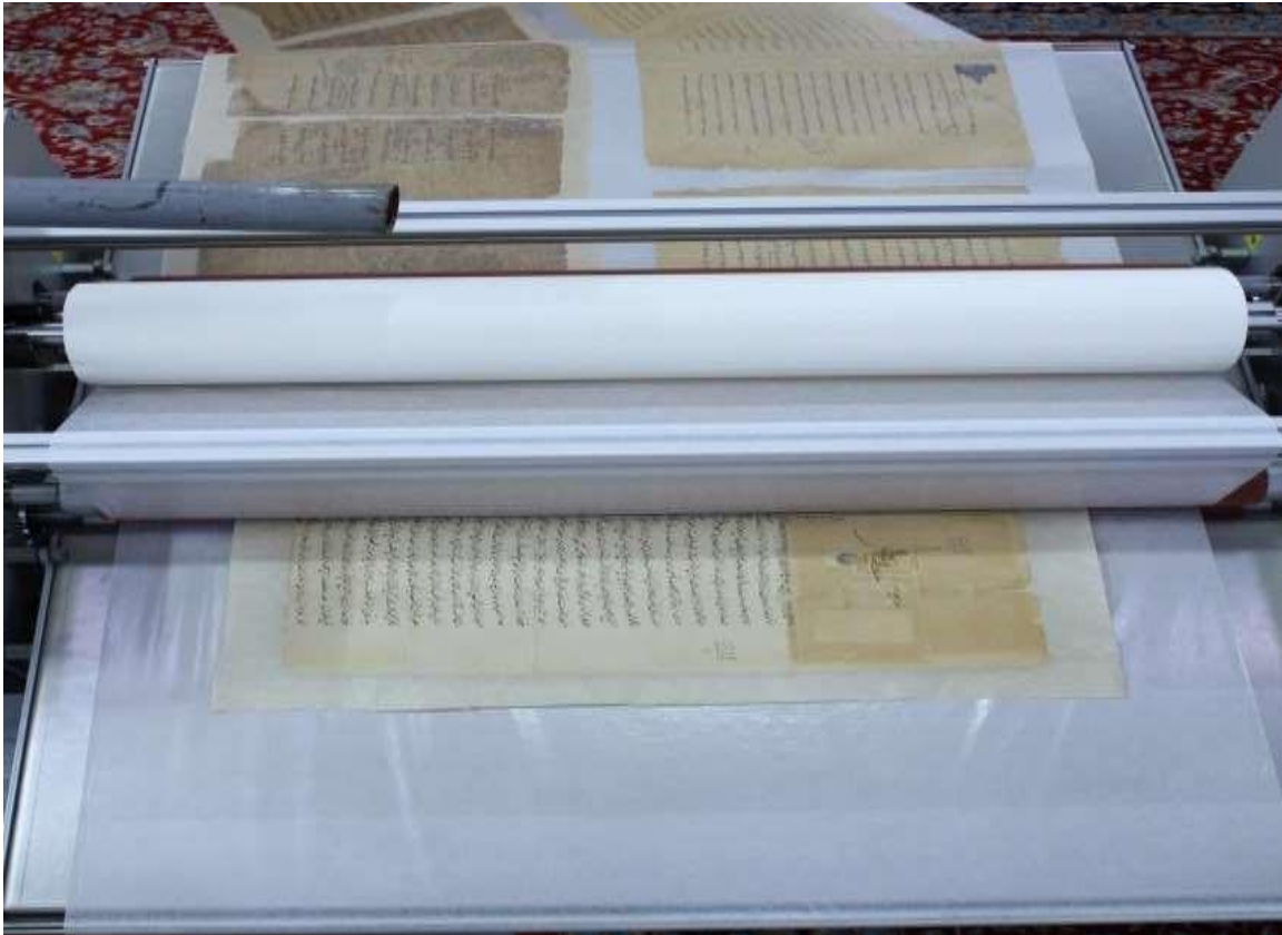
الوثيقة 5598 عملية تدعيمها من الجهتين بمادة الورق الياباني التقني (filmoplast R) بواسطة جهاز كبس وتدعيم الوثائق
