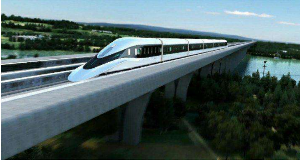
الشكل ( 3 - 8 ) مجال مغناطيسي قوي يعمل على تكوين وسادة مغناطيسية ترفع القطار وتمنعه من ملامسة السكة الحديدية
