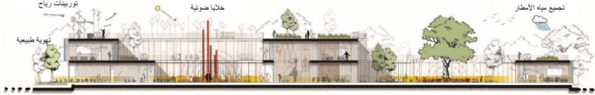
مقطع يوضح تقنيات الاستدامة المستخدمة . (ابو السعود & مجدي ، مقال منشور ، 2020)
