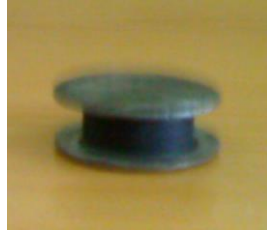
شكل رقم (2-3) يوضح عينة فحص الزحف
