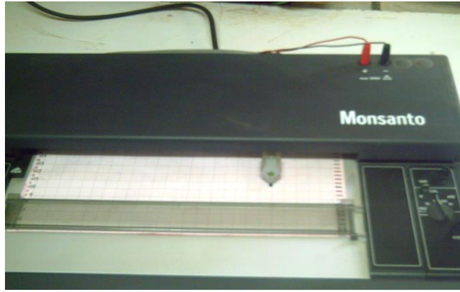
شكل رقم (3-10) يمثل الراسم البياني المستخدم لحساب القص
