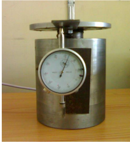
شكل رقم (7-3) يوضح فحص الزحف
