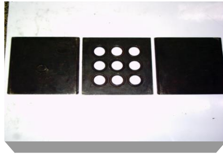
شكل رقم (2-3) قالب لإنتاج عينات فحص الصلادة والصدمة والكثافة .
