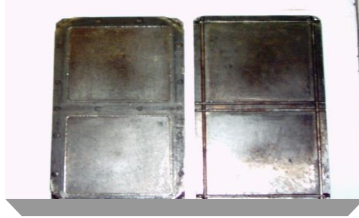
شكل رقم (3-3) قالب لإنتاج عينات فحص الشد والاستطالة ومعامل المرونة .
