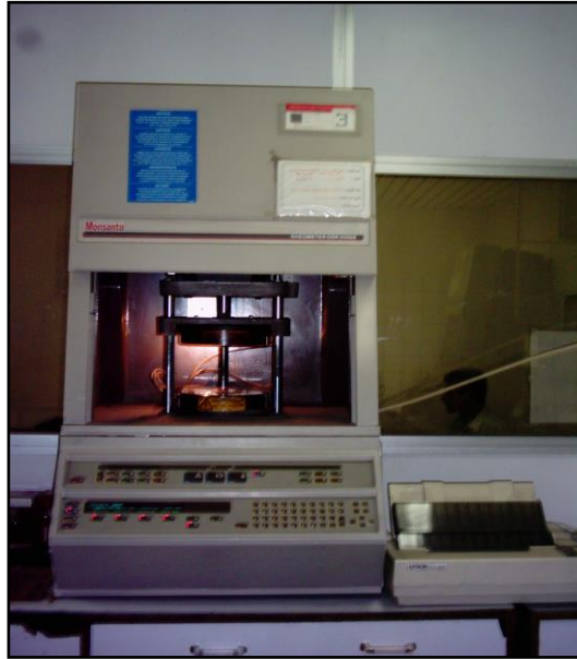
شكل رقم (A8-3) جهاز قياس الانسيابية ODR
