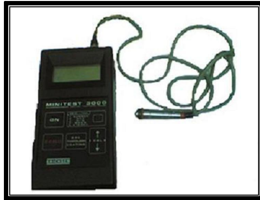
الشكل (5-3) يبين جهاز قياس السمك .
