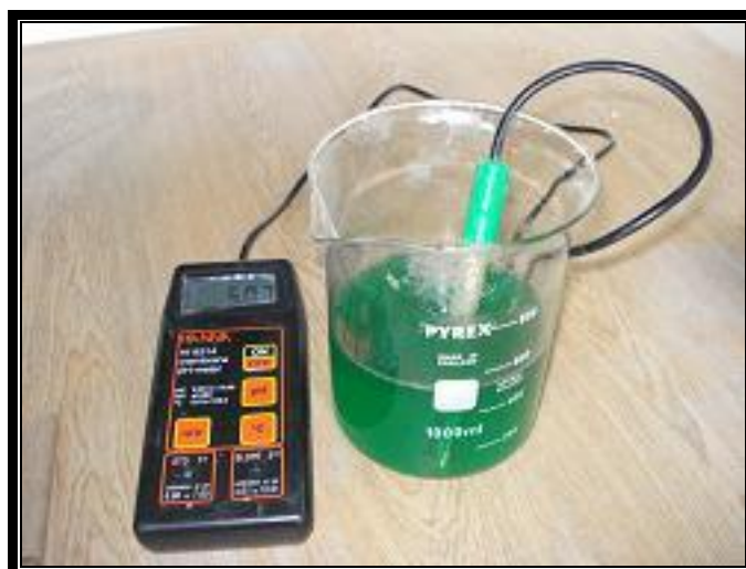
الشكل (3-4) يبين جهاز قياس الاس الهيدروجيني .
