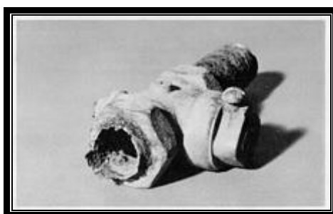
الشكل (2-1) يوضح التآكل الكلفاني ، [16] .
