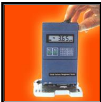
الشكل (7-3) يوضح جهاز اختبار خشونة السطح .
