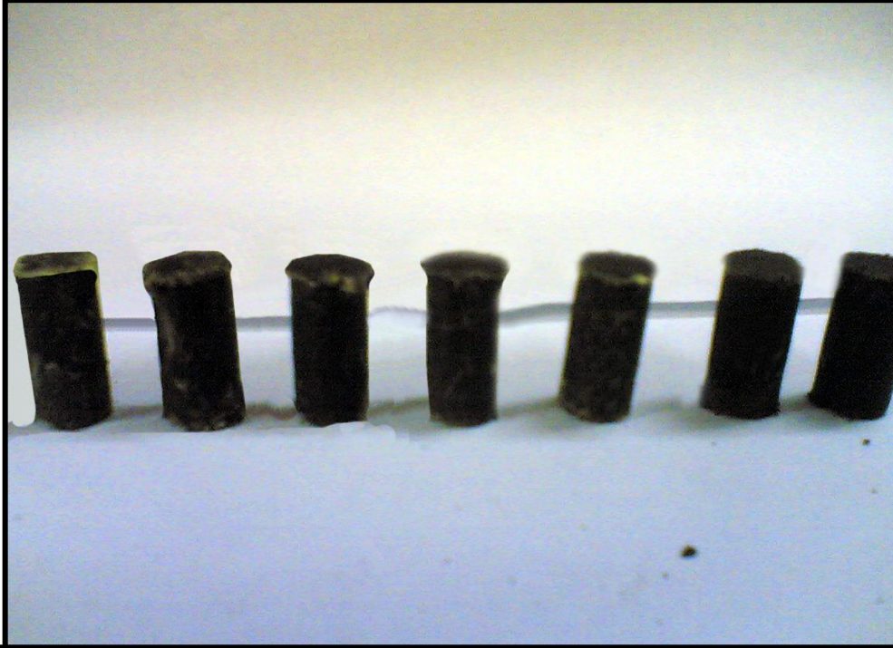
شكل رقم (7-3) يوضح عينات اختبار الصلادة والموصلية
