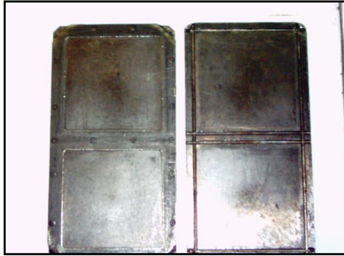
الشكل (3-5) قالب لإنتاج عينات فحص خواص الشد .
