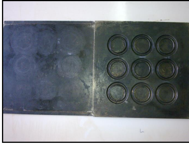
الشكل (3-4) قالب لانتاج عينات فحص الصلادة والارتدادية والوزن النوعي
