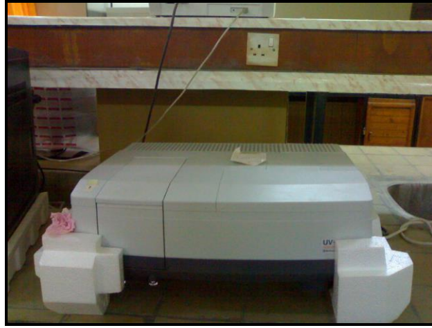
الشكل (3-12) جهاز UV- Visible spectrometer
