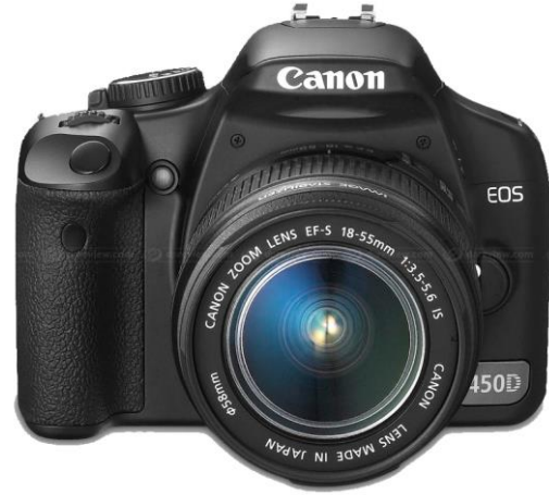
شكل يمثل كاميرا رقمية مع متحسس صوري نوع (CCD)
