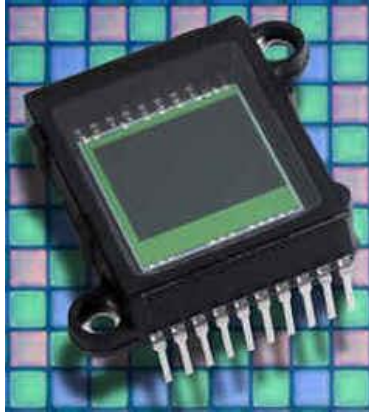
شكل يمثل كاميرا رقمية مع متحسس صوري نوع (CCD)
