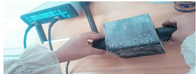
Figure 8: UPV (Pundit Lab+).
