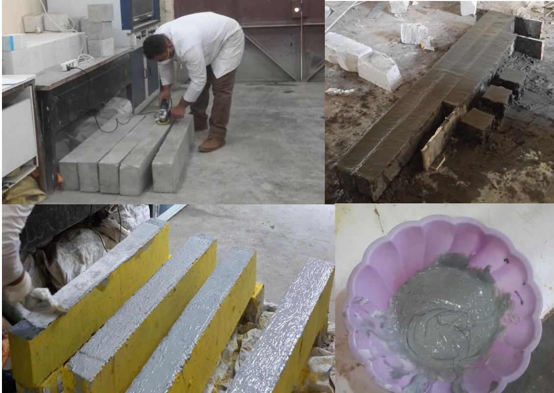
شكل (١٢):- يوضح عملية صب و تقوية العتبات الخرسانية المسلحة بألياف.
