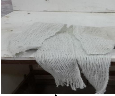
الألياف البلاستيكية بعد غزلها و نسجها
