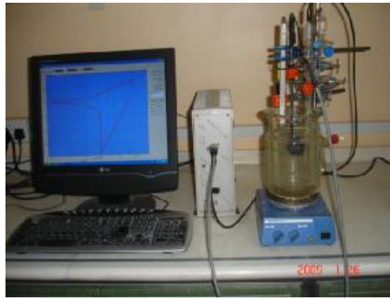
الشكل ( 1 ) جهاز اختبار التآكل بالطريقة الكهروكيميائية .
