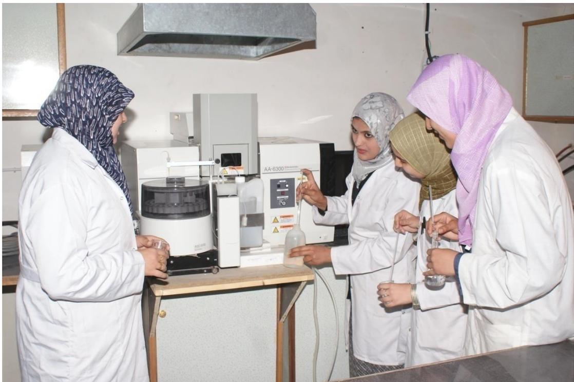
مطياف الامتصاص الذري AA-6300 Atomic Absorption Spectrometer (Shimadzu)
