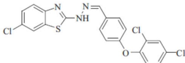
Fig. 11: Structure of 2-(2-(4-arylxybenzylidene)hydrazinyl)benzthiazole
